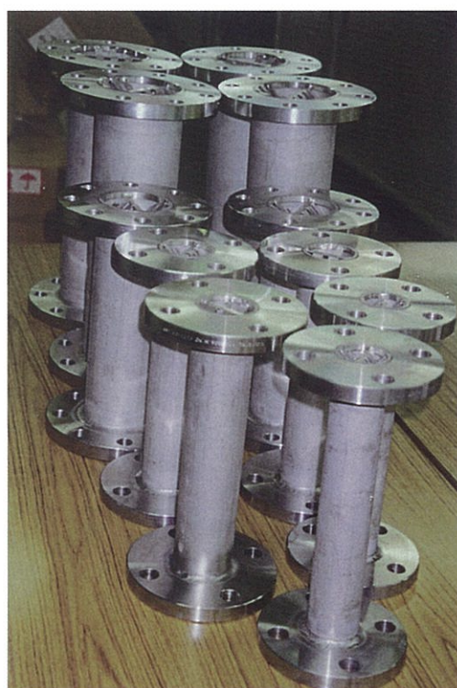
▼污水处理場薬品混合用
